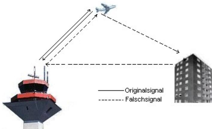
BI-Radar ist ein Spezialglas, das eine Dämpfung unerwünschter Radarreflexionen an Gebäudefassaden ermöglicht.
